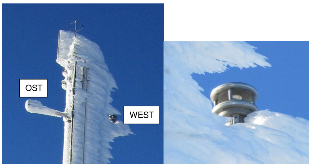
Abbildung 9: Links: Mastspitze bei einem starken Vereisungsereignis am 10.1.2012. Rechts: Zoom auf den Ventus Windsensor.
